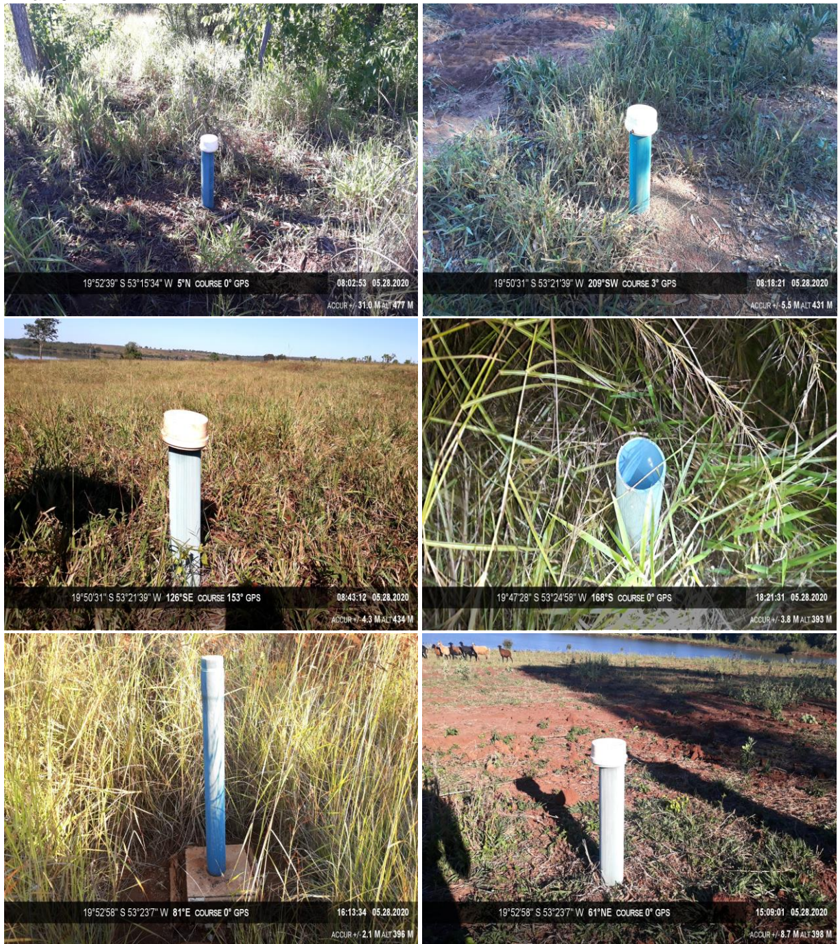
Figura 1 - Poços de monitoramento da PCH Verde 4A. Da esquerda para a direita - cima para baixo: P1 a P6.
