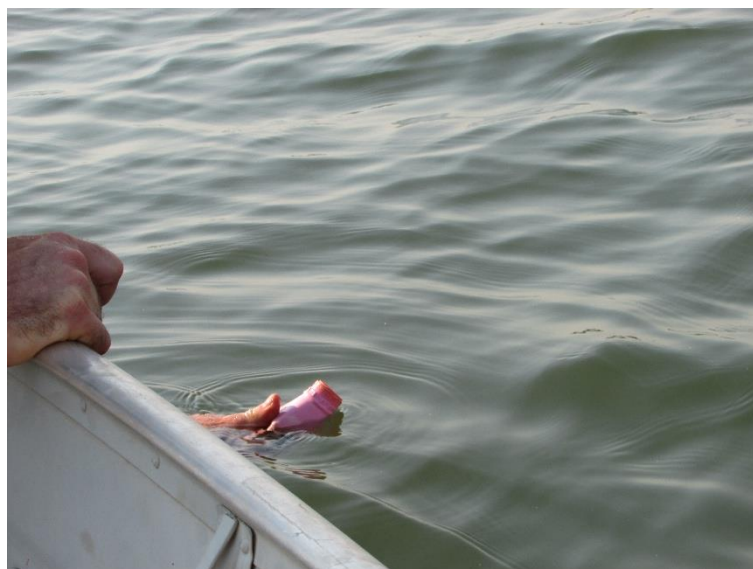
Figura 5. Coleta de água superficial para o monitoramento de fitoplâncton no reservatório intermediário, PCH Verde 4A, Água Clara, MS. Abril de 2020.
